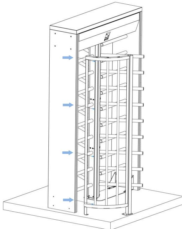
Se procede a marcar los agujeros de fijación en el piso, se perfora y colocan las varillas con pegamento epoxi (Fischer vs 300t).
