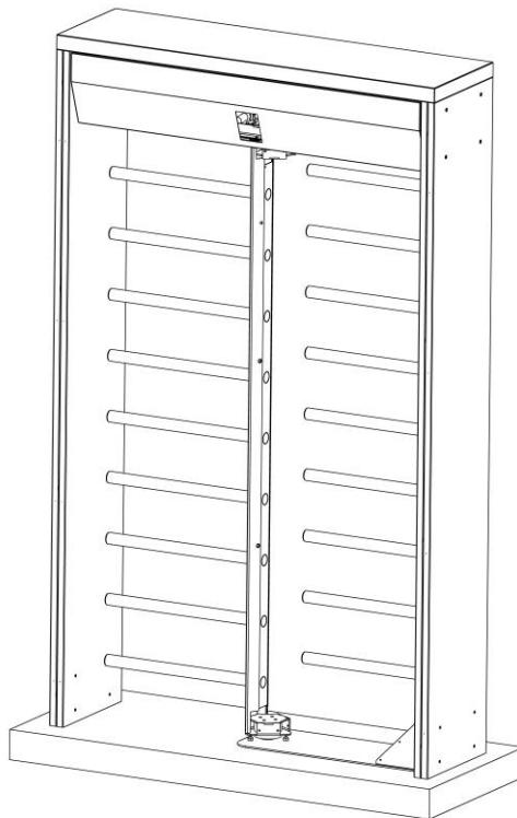
Una vez ubicados los perfiles del eje principal, proceder a fijarlos con sus respectivos tornillos.
