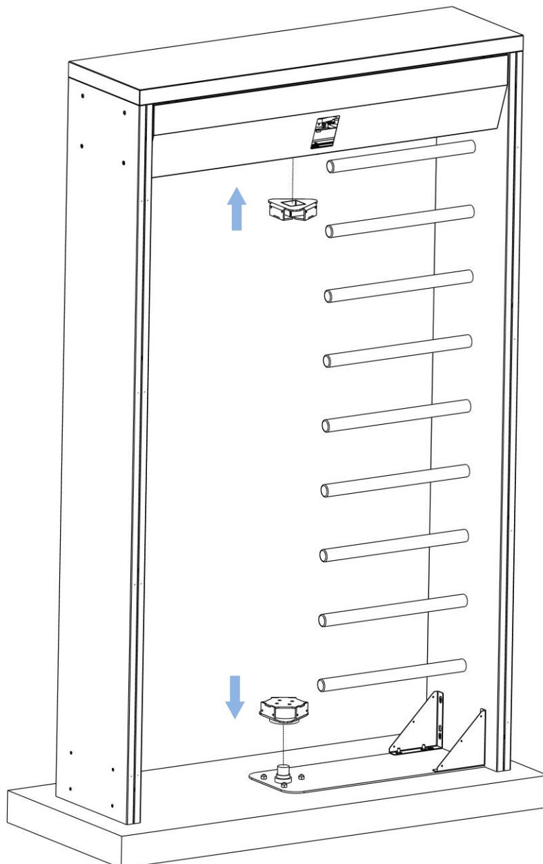
Una vez posicionada las zapatas, alinear unas de sus caras planas hacia la columna lateral.
