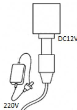
El molinete MC310 requiere una fuente de alimentación individual de 12Vdc.
