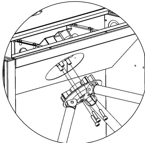
Instale los tres tornillos de fijación y ajústelos firmemente de manera uniforme.
