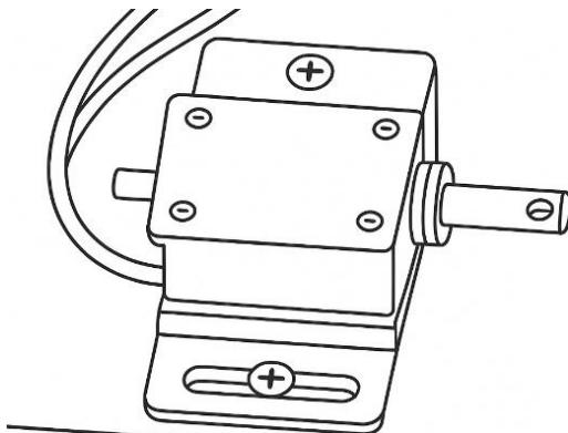
Los solenoides encargados de bloquear o no el giro del mecanismo. Si se detecta la falla de alguno de estos componentes se deberá realizar los siguientes pasos:
